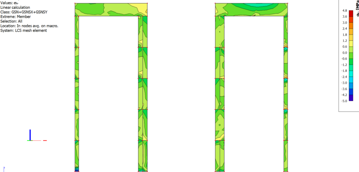
Slika 9.1.11. Naprezanja \sigma_x za anvelopu opterećenja (GSNSX+GSNSY+GSN)
