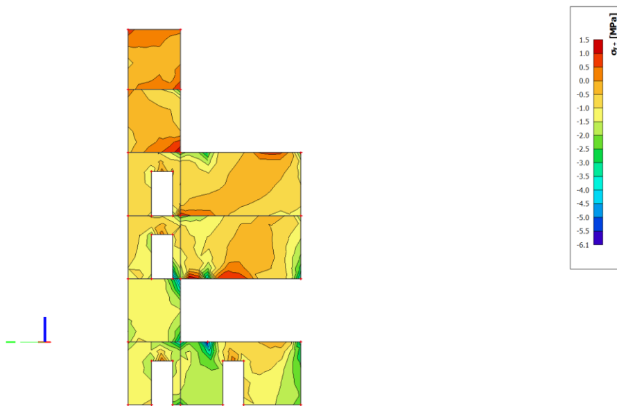
Slika 9.1.37. Naprezanja \sigma_y za anvelopu opterećenja (GSNSX+GSNSY+GSN)
