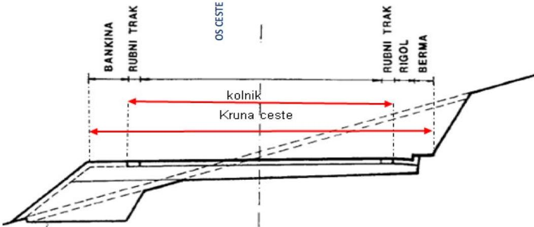
*Slika 4. Osnovni elementi poprečnog presjeka ceste [5]*
