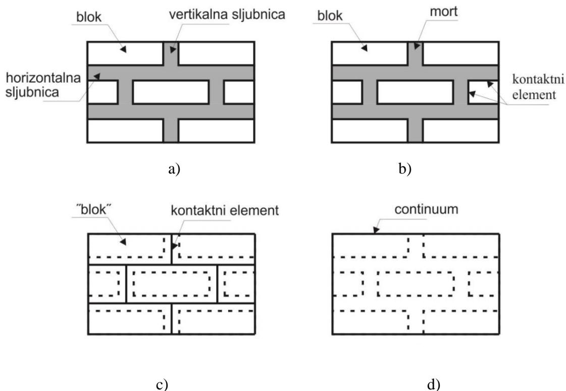
Slika 1. Prikaz razina modeliranja zida: a) Prikaz elemenata zida; b) Mikromodeliranje; c) Pojednostavljeni mikromodeliranje; d) Makromodeliranje [2]
