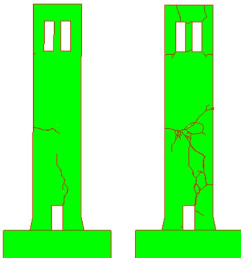
1)  $t=11,00 \text{ s}$ 2)  $t=30,15 \text{ s}$ *Slika 16. Prikaz nastanka i širenja pukotina pri vršnom ubrzavanju tla 5.25g*
