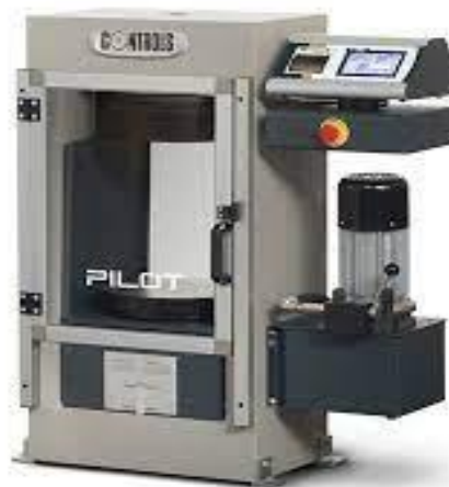
Slika 4.1. Uređaj za ispitivanje karakteristične tlačne čvrstoće
