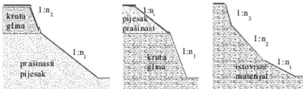
Slika 4. Kosine promjenjivih nagiba kroz različita tla i homogena kosina promjenjivog nagiba [1]
