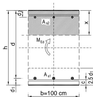
$w_k = 0,096 \text{ mm} < w_g = 0,3 \text{ mm} \rightarrow \text{Pukotine zadovoljavaju!}$
