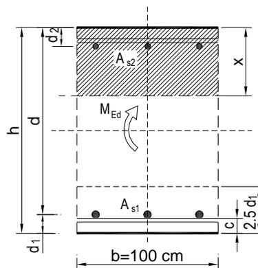
$$w_k = 0,018 \text{ mm} < w_g = 0,3 \text{ mm} \rightarrow \text{Pukotine zadovoljavaju !}$$
