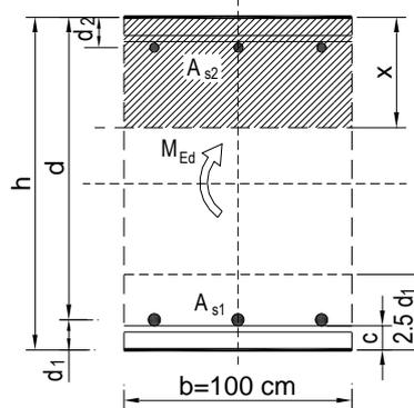
$w_k = 0,200 \text{ mm} < w_g = 0,3 \text{ mm} \rightarrow$  **Pukotine zadovoljavaju!**
