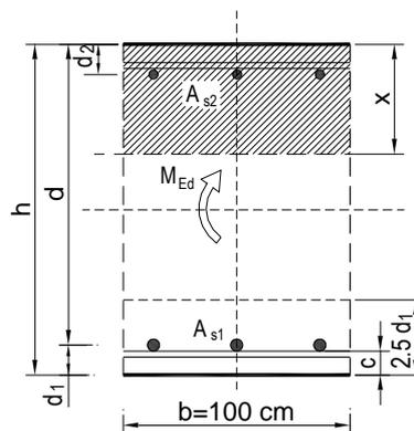
$$w_k = 0,078 \text{ mm} < w_g = 0,3 \text{ mm} \rightarrow \text{Pukotine zadovoljavaju !}$$
