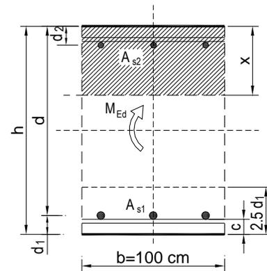
$$w_k = 0,168 \text{ mm} < w_g = 0,3 \text{ mm} \rightarrow \text{Pukotine zadovoljavaju!}$$
