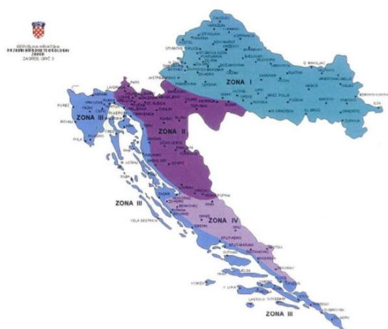
Slika 7.1. Karta i tablica karakterističnih vrijednosti opterećenja snijegom obzirom na područje
