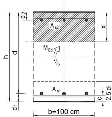
$w_k = 0,131 \text{ mm} < w_g = 0,3 \text{ mm} \rightarrow$  **Pukotine zadovoljavaju!**
