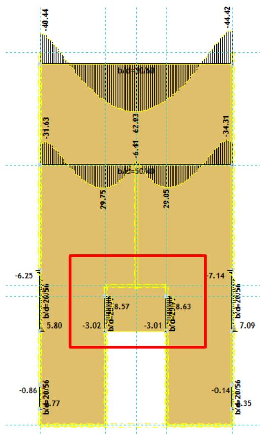
Slika 12.15. Moment savijanja  $M_y$ - GSUGranična vrijednost širine pukotine  $\rightarrow w_g = 0,3 \text{ mm}$ Računska vrijednost širine pukotine  $\rightarrow w_k = s_{r,max} \cdot (\epsilon_{sm} - \epsilon_{cm})$
