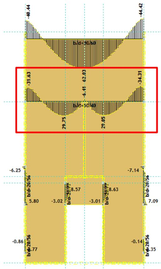
Slika 12.11. Moment savijanja  $M_y$ - GSUGranična vrijednost širine pukotine  $\rightarrow w_g = 0,3 \text{ mm}$ Računska vrijednost širine pukotine  $\rightarrow w_k = s_{r,max} \cdot (\epsilon_{sm} - \epsilon_{cm})$
