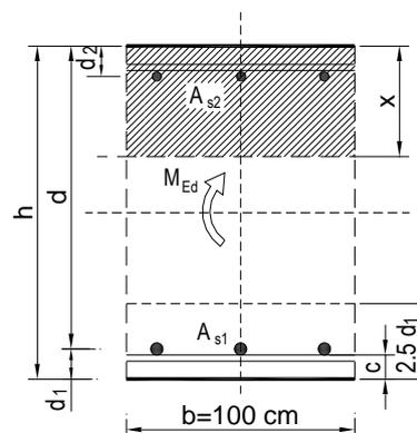
$w_k = 0,139 \text{ mm} < w_g = 0,3 \text{ mm} \rightarrow \text{Pukotine zadovoljavaju!}$
