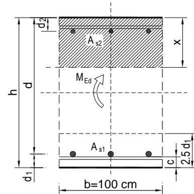
$$w_k = 0,030 \text{ mm} < w_g = 0,3 \text{ mm} \rightarrow \text{Pukotine zadovoljavaju!}$$
