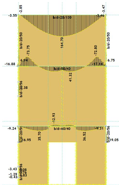
Slika 12.20. Moment savijanja  $M_y$ - GSUGranična vrijednost širine pukotine  $\rightarrow w_g = 0,3 \text{ mm}$ Računska vrijednost širine pukotine  $\rightarrow w_k = s_{r,max} \cdot (\epsilon_{sm} - \epsilon_{cm})$
