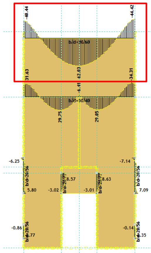
Slika 12.9. Moment savijanja  $M_y$ - GSUGranična vrijednost širine pukotine  $\rightarrow w_g = 0,3 \text{ mm}$ Računska vrijednost širine pukotine  $\rightarrow w_k = s_{r,max} \cdot (\epsilon_{sm} - \epsilon_{cm})$
