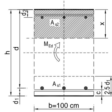
$$w_k = 0,084 \text{ mm} < w_g = 0,3 \text{ mm} \rightarrow \text{Pukotine zadovoljavaju!}$$
