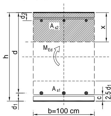
$w_k = 0,152 \text{ mm} < w_g = 0,3 \text{ mm} \rightarrow$  **Pukotine zadovoljavaju!**
