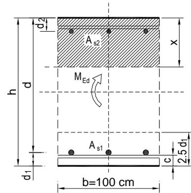
$w_k = 0,027 \text{ mm} < w_g = 0,3 \text{ mm} \rightarrow$  **Pukotine zadovoljavaju!**
