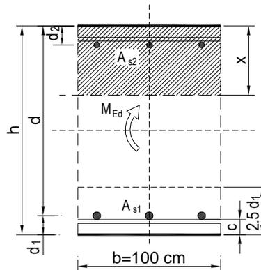
$$w_k = 0,054 \text{ mm} < w_g = 0,3 \text{ mm} \rightarrow \text{Pukotine zadovoljavaju !}$$
