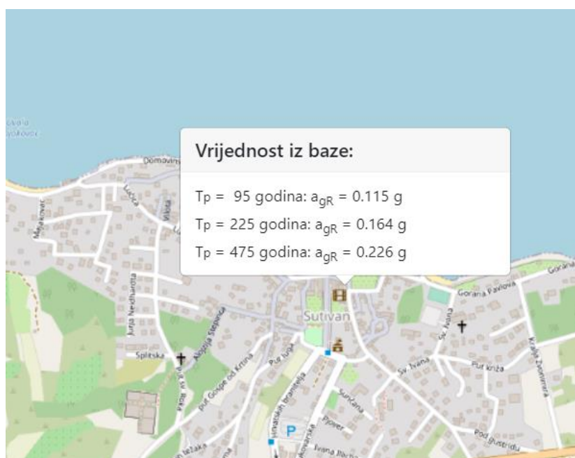
Slika 7.5. Parametar vršnog ubrzanja tla za promatranu lokaciju (Sutivan)
