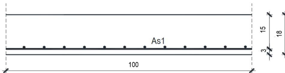
Slika 11.4. Poprečni presjek ploče
