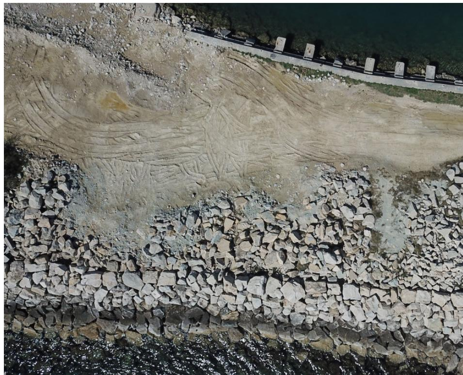
*Slika 8.1.3. Postojeći lukobran s brojnim vidljivim oštećenjima*
