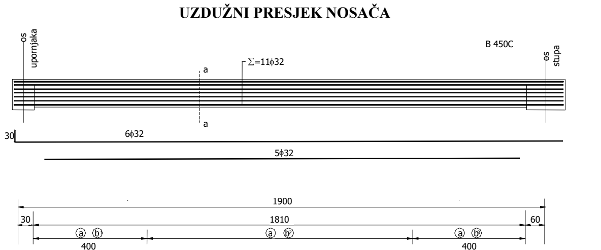
Slika 32. Prikaz armiranja uzdužnog nosača u polju
