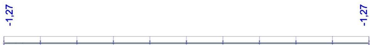
Slika 2.22 Prikaz stalnog opterećenja od krovne plohe ( $G_{kp}$ )
