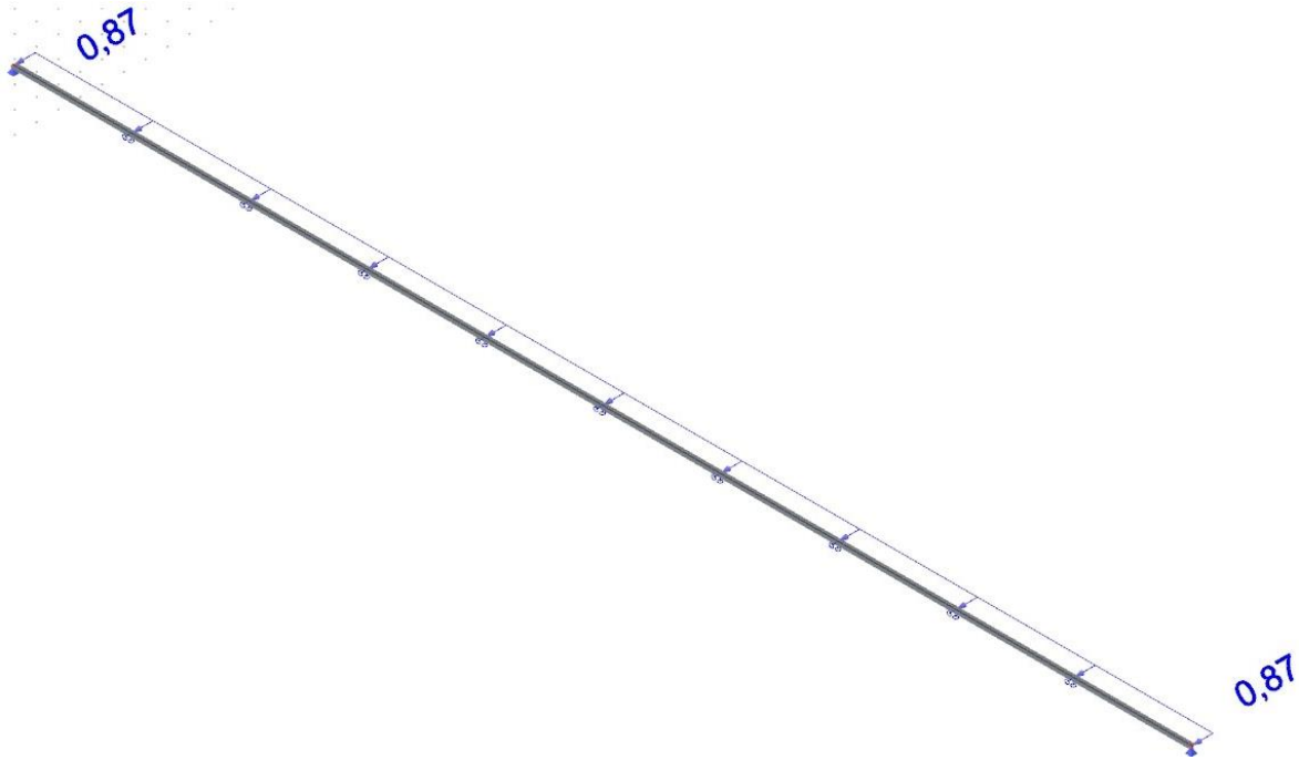
Slika 2.29 Prikaz promjenjivog opterećenja od vjetra ( W_2 )
