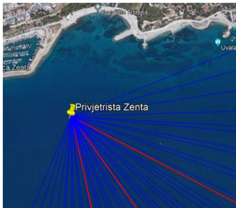
Slika 4.1.2. Efektivno privjetrište za sektor I
