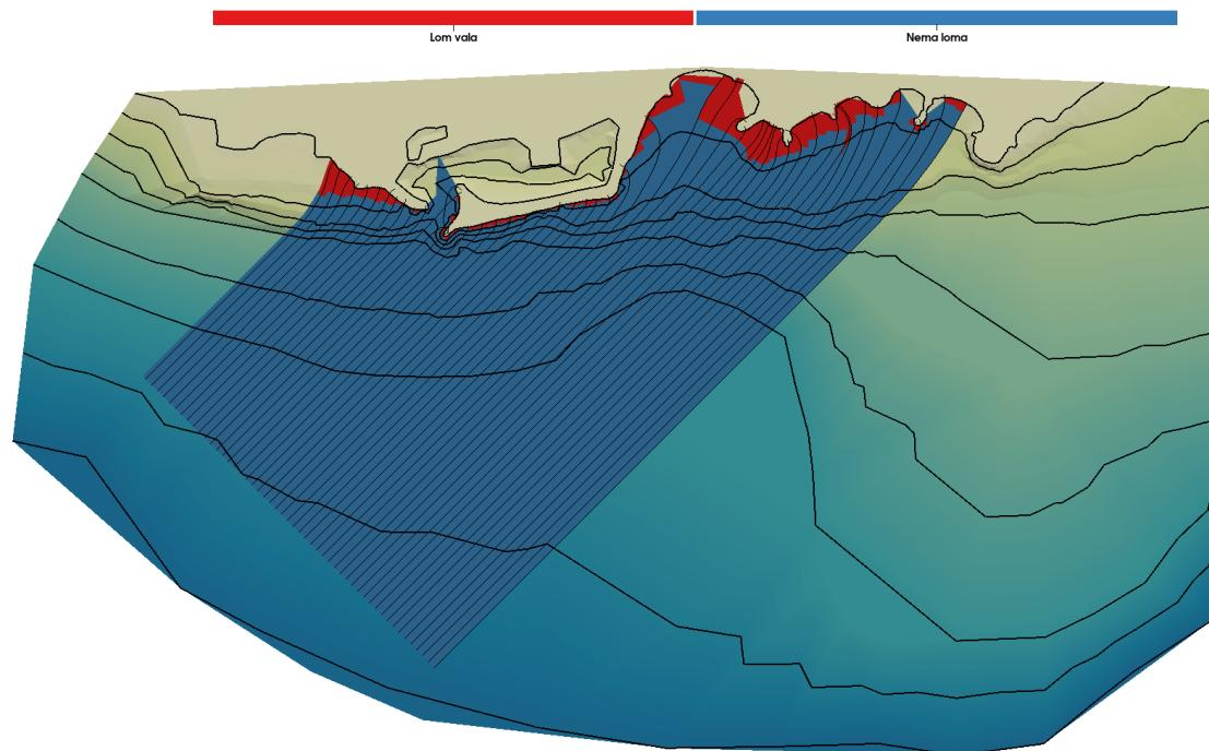
*Slika 5.3.3. Detekcija loma vala za Sektor II: petogodišnji val ( $H_s^{100}=2.60\text{ m}$ ,  $T_0^{100}=4.91\text{ s}$ )*
