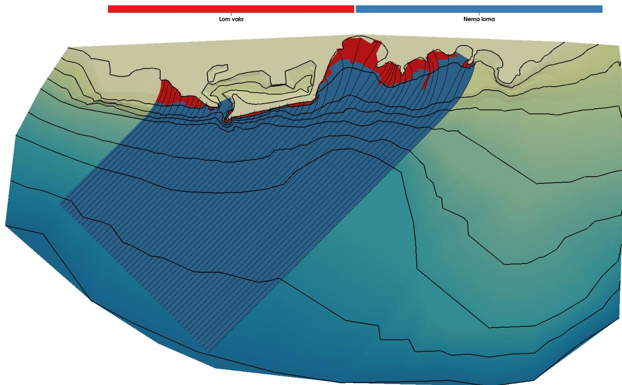
*Slika 5.3.4. Detekcija loma vala za Sektor II: stogodišnji val ( $H_s^{100}=3.62\text{ m}$ ,  $T_0^{100}=5.98\text{ s}$ )*
