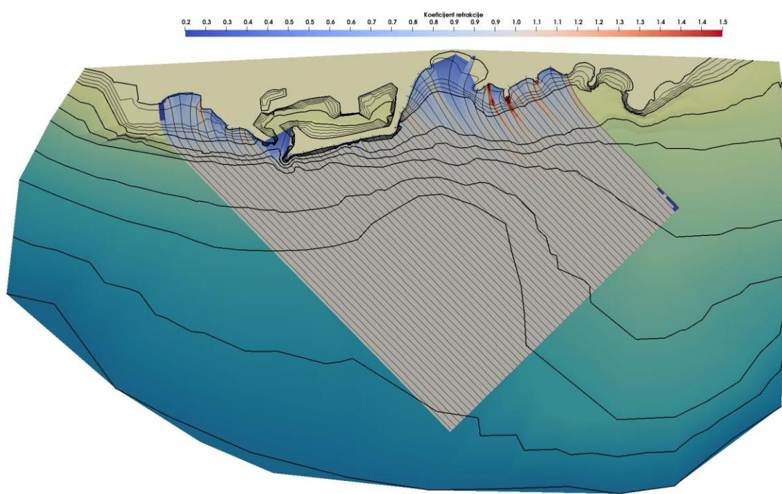
*Slika 5.1.2. Plan refrakcije za Sektor I: petogodišnji val ( $H_s^{100}=2.92 \text{ m}$ ,  $T_0^{100}=4.94 \text{ s}$ )*
