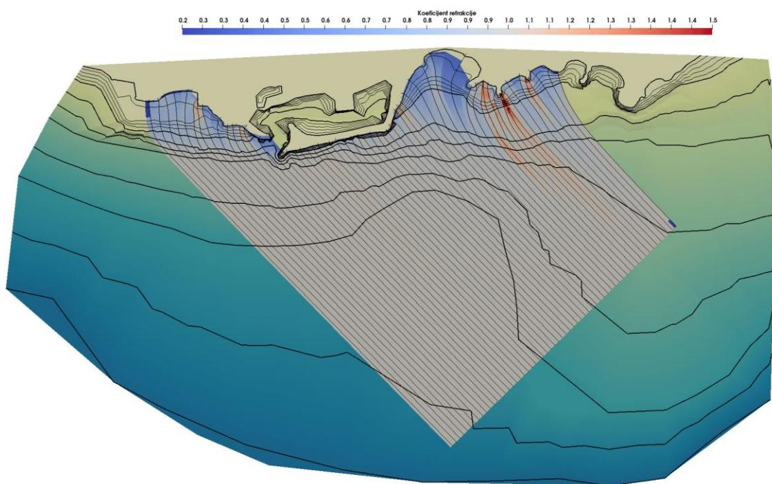
*Slika 5.1.3. Plan refrakcije za Sektor I: stogodišnji val ( $H_s^{100}=3.73 \text{ m}$ ,  $T_0^{100}=5.78 \text{ s}$ )*
