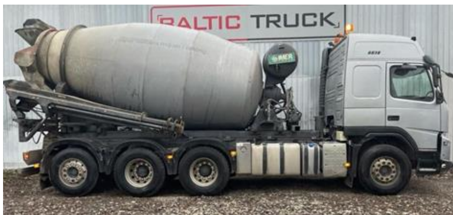
Slika 5.5 Automješalica VOLVO FMX 500 [8]
