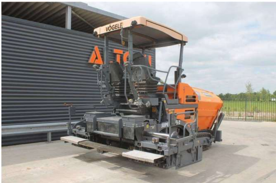
Slika 4.6 Finišer VÖGELE SUPER 1300-2 ERGOPLUS [9]
