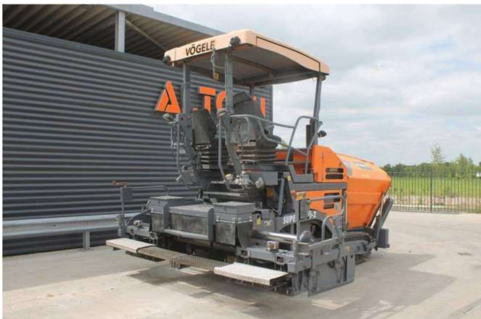
Slika 4.6 Finišer VÖGELE SUPER 1300-2 ERGOPLUS [9]
