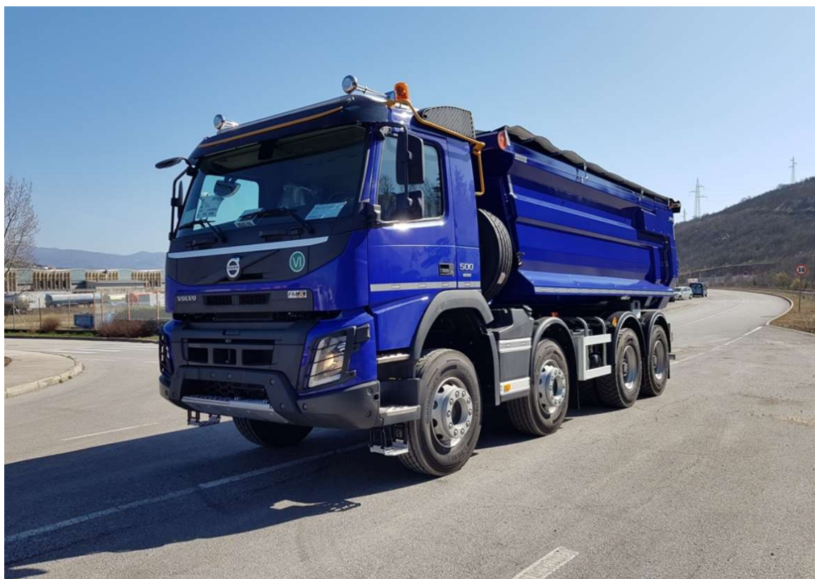
Slika 4.8 Kamion kiper Volvo FMX 500 HP-8x4 BB [11]
