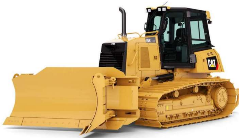
Slika 4.1 Dozer CAT D6K [4]
