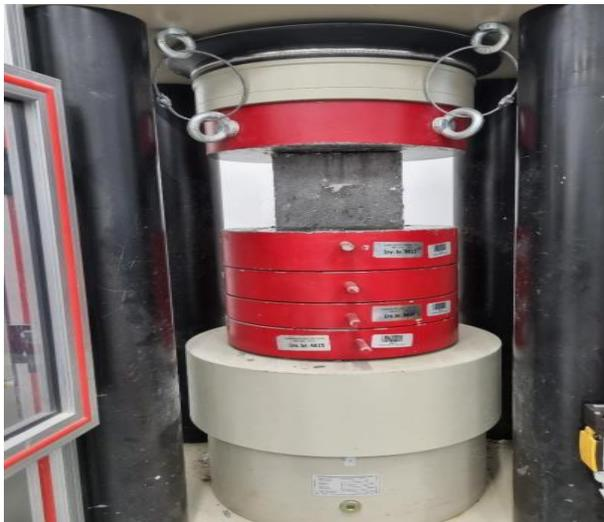
Slika 4.4.5 Ispitivanje tlačne čvrstoće [5]
