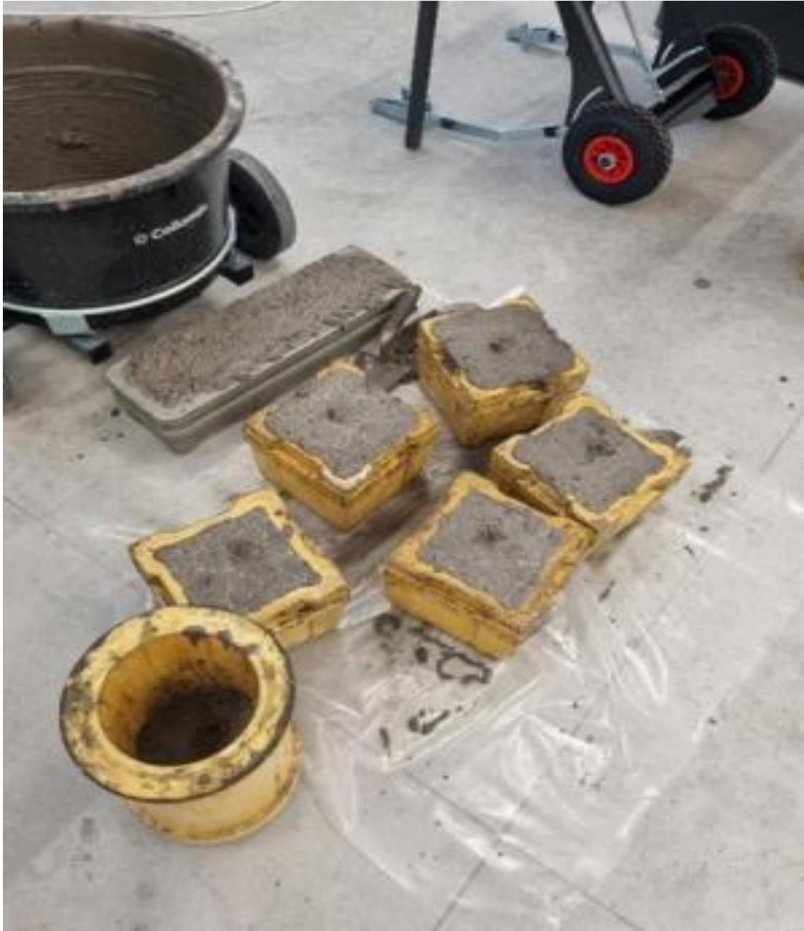
*Slika 4.3 Izrada betona pomoću kalupa [5]*
