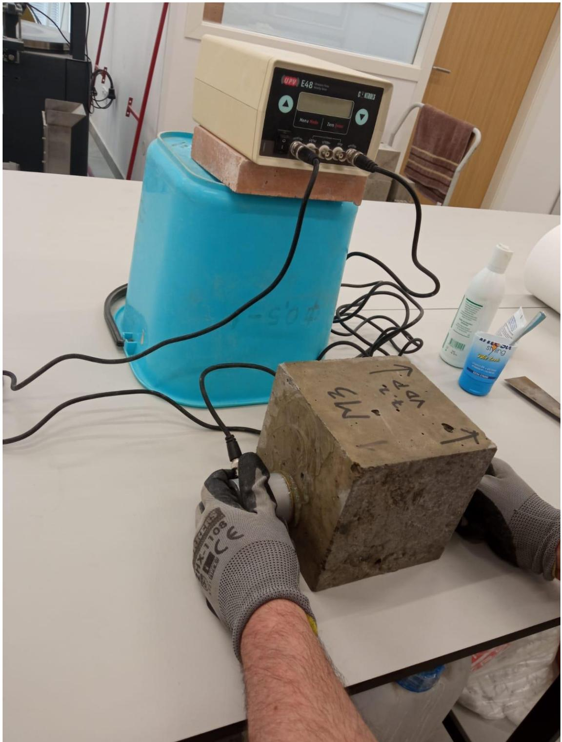
*Slika 4.4.7 Ispitivanje brzine širenja ultrazvučnih valova u betonu*
