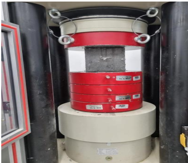
Slika 4.4.5 Ispitivanje tlačne čvrstoće [5]
