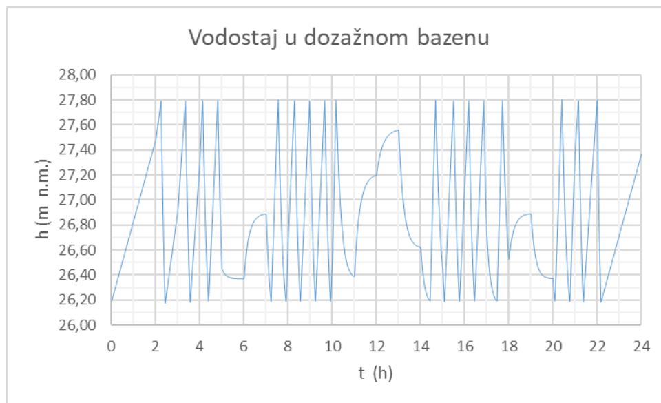
Slika 4.8. Vodostaj u dozažnom bazenu za maksimalni satni protok od 70 (l/s)
