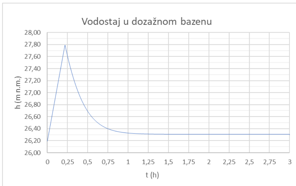
Slika 4.21. Vodostaj u dozažnom bazenu za varijantu 4
