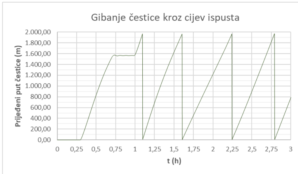
Slika 4.38. Gibanje čestice kroz cijev ispusta za varijantu 6
