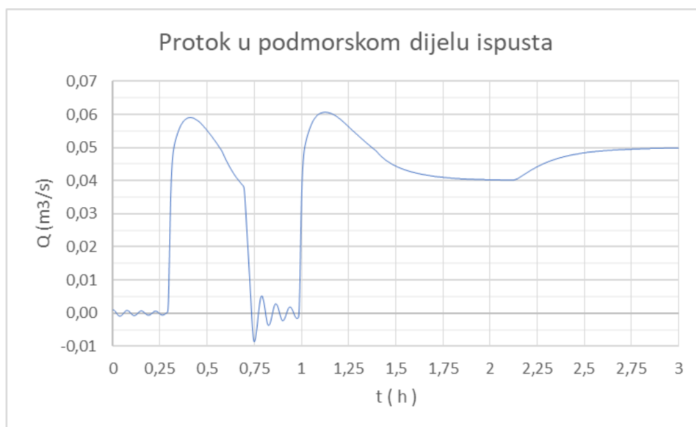
Slika 4.37. Protok u podmorskom dijelu ispusta za varijantu 6
