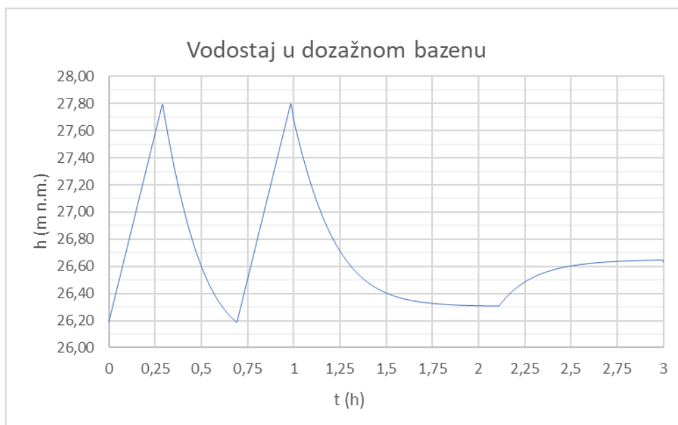
Slika 4.33. Vodostaj u dozažnom bazenu za varijantu 6
