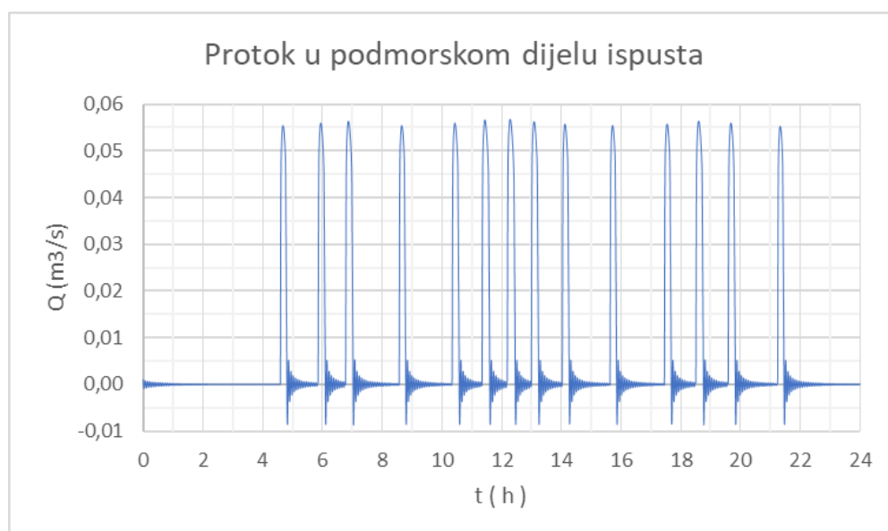
Slika 4.18. Protok u podmorskom dijelu ispusta za maksimalni satni protok od 15 (l/s)
