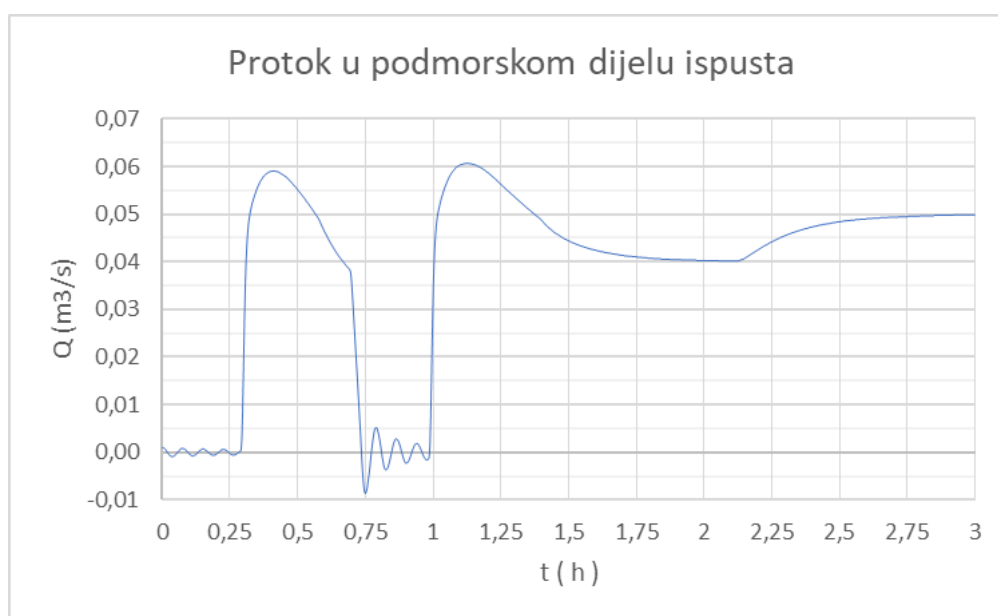
Slika 4.37. Protok u podmorskom dijelu ispusta za varijantu 6
