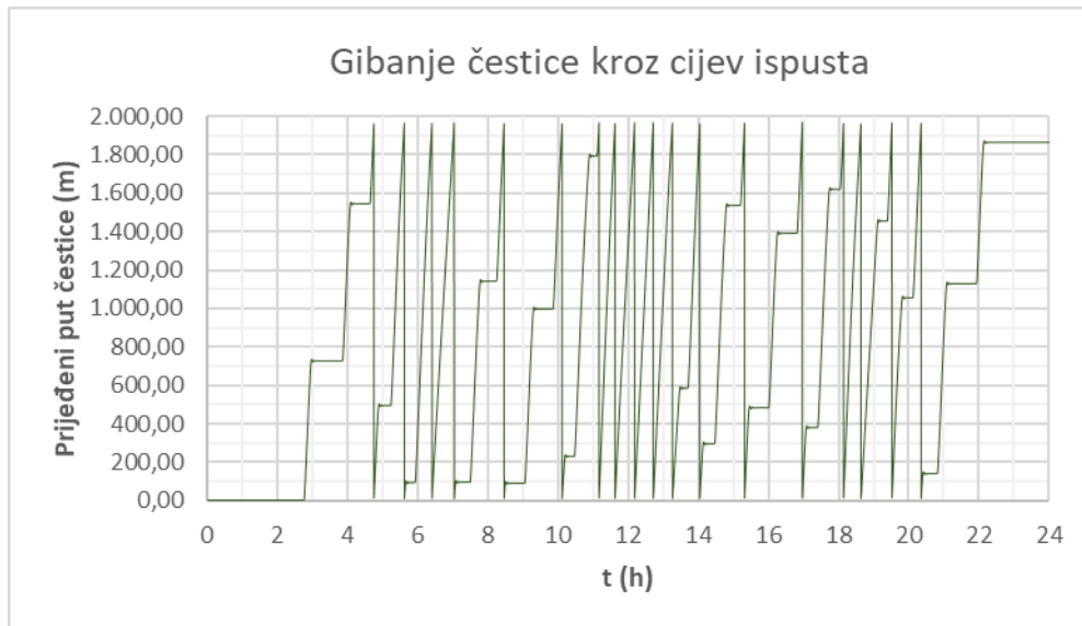
Slika 4.7. Prijedeni put čestice efluenta u cijevi ispusta za maksimalni satni protok od 50 (l/s)
