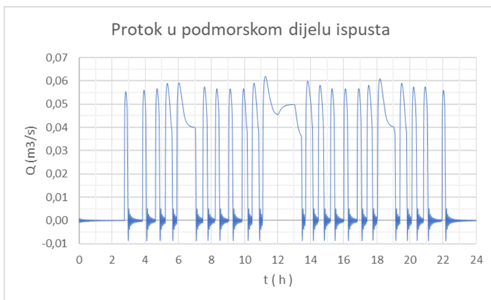
Slika 4.5. Protok u podmorskom dijelu ispusta za maksimalni satni protok od 50 (l/s)
