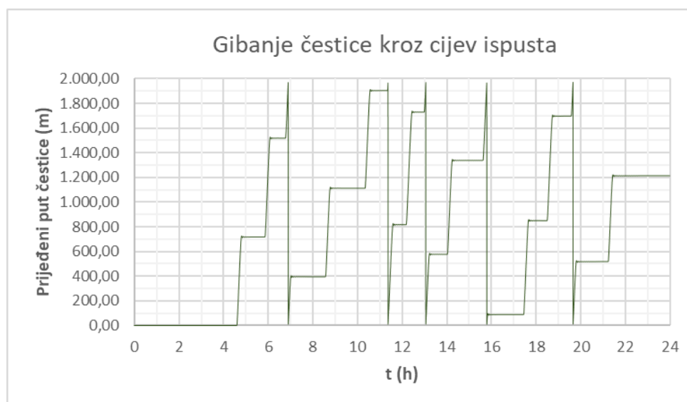
Slika 4.20. Gibanje čestice kroz cijev ispusta za maksimalni satni protok od 15 (l/s)
