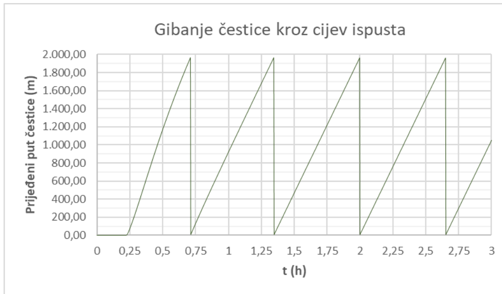
Slika 4.26. Gibanje čestice efluenta kroz cijev ispusta za varijantu 4
