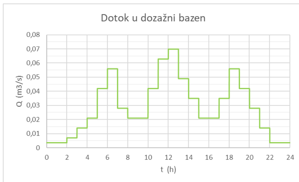
Slika 4.9. Dotok u dozažni bazen za maksimalni satni protok od 70 (l/s)
