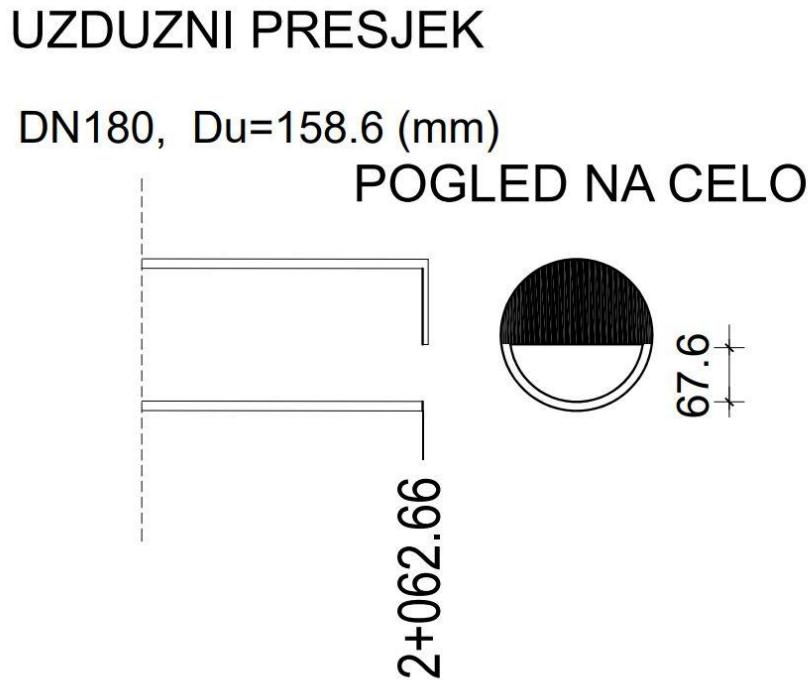
Slika 2. 5. Uzdužni presjek čelnog otvora difuzora [1]
