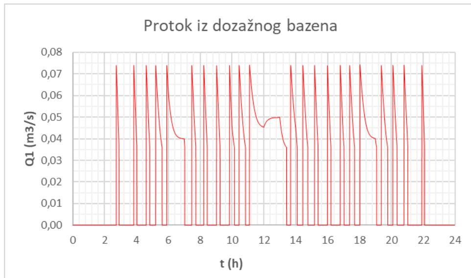
Slika 4.3. Protok iz dozažnog bazena u cjevovod podmorskog ispusta za maksimalni satni protok od 50 (l/s)
