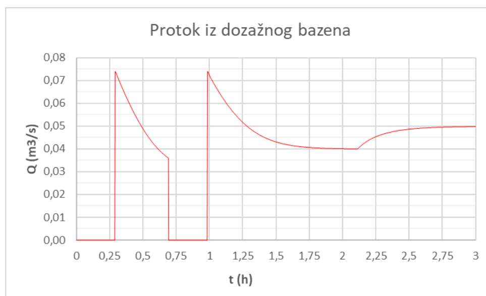
Slika 4.35. Protok iz dozažnog bazena za varijantu 6
