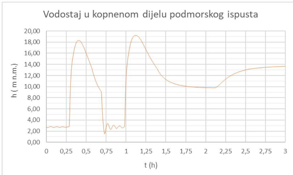
Slika 4.36. Vodostaj u kopnenom dijelu ispusta za varijantu 6
