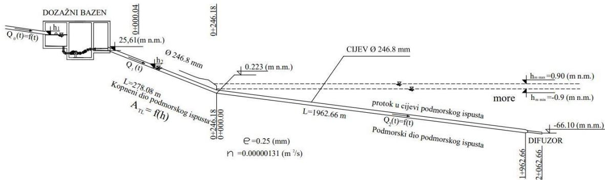
*Slika 3.1. Shematski prikaz cjelokupnog sustava podmorskog ispusta*
