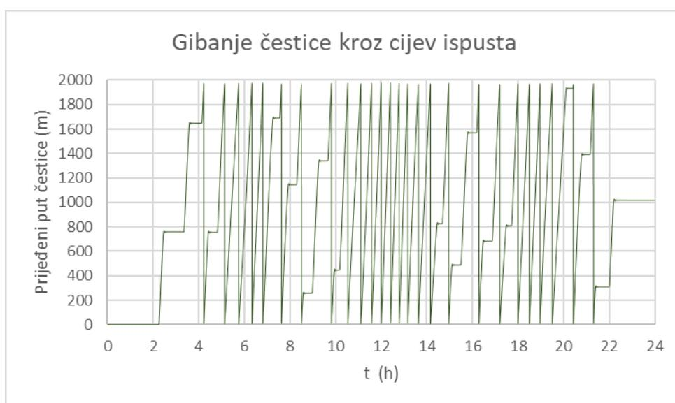
Slika 4.14. Gibanje čestice kroz cijevi ispusta za maksimalni satni protok od 70 (l/s)
