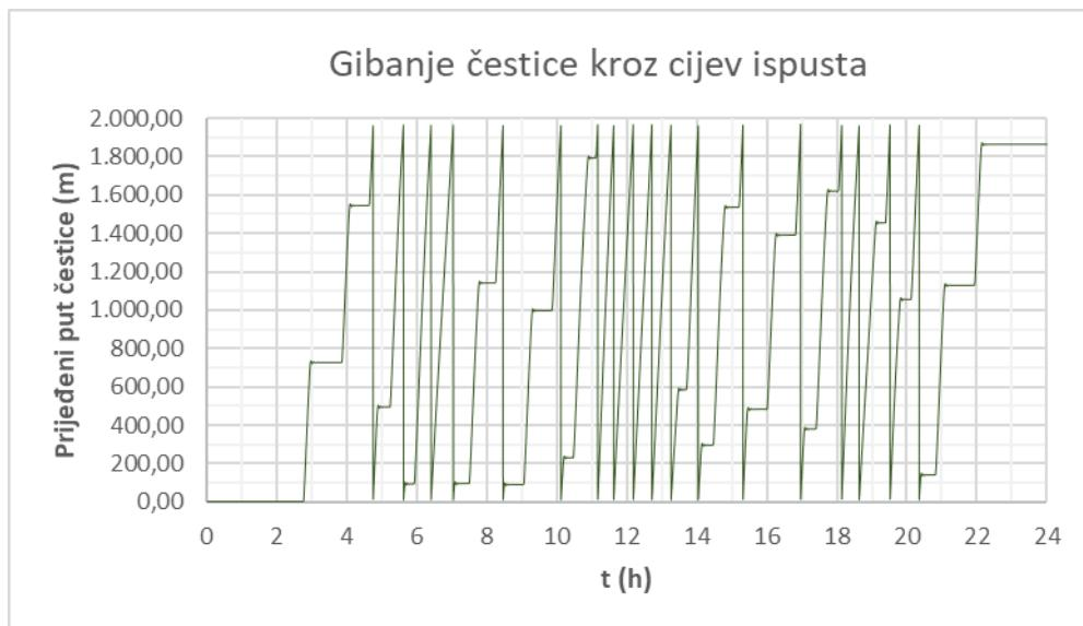
*Slika 4.7. Prijedjeni put čestice efluenta u cijevi ispusta za maksimalni satni protok od 50 (l/s)*
