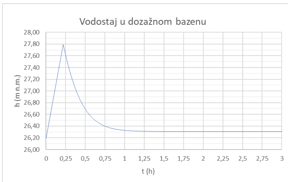
Slika 4.21. Vodostaj u dozažnom bazenu za varijantu 4
