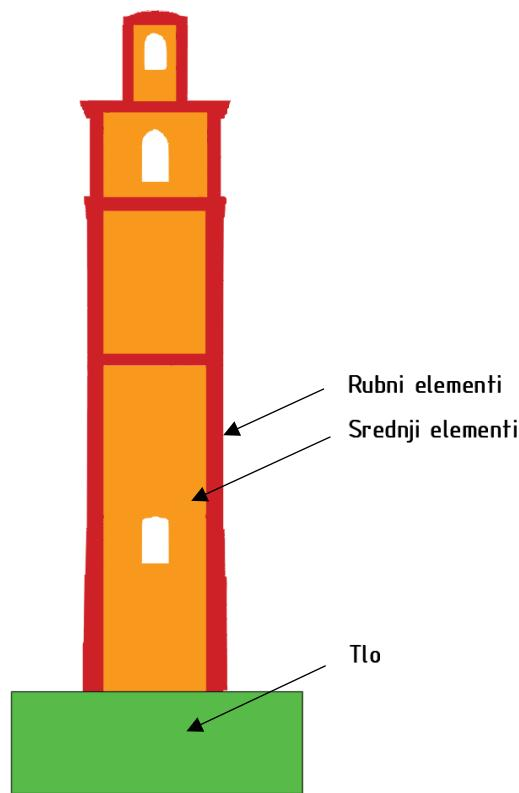
**Slika 10.** Različiti elementi za pripadajuću konstrukciju
