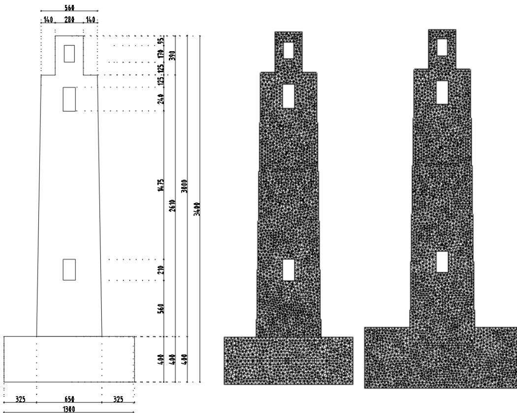
**Slika 11.** a) Pojednostavljeni računski model b) diskretiziran model za model sa slobodnim oslanjanjem na elastičnoj podlozi, krutoj podlozi i upete u tlo c) diskretiziran model sa ukopanim rubnim uvjetima
