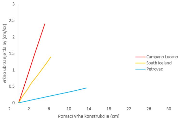
Slika 196. Pomaci vrha konstrukcije za ukopanu konstrukciju
