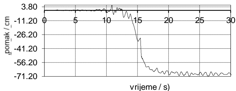
Slika 105. Vršno ubrzanje a_g = 2.60 g za Campano Lucano, potpuni slom
