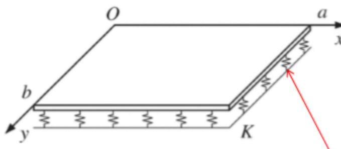
Slika 8.1 Međudjelovanje konstrukcija – tlo modelirano Winkler- ovim modelom
