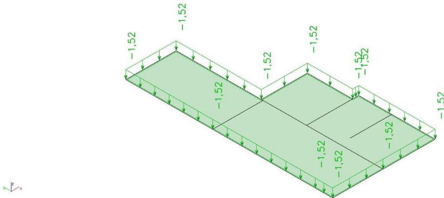
Slika 4.1.1 Dodatno stalno djelovanje  $G_1$  [ $\text{kN/m}^2$ ]
