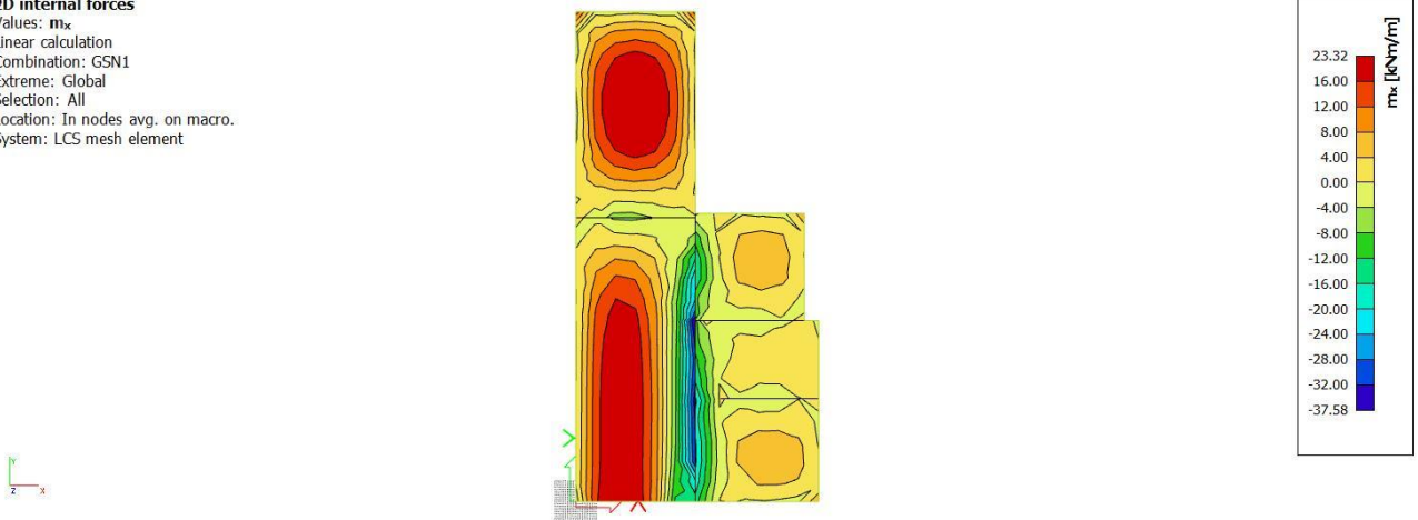
Slika 6.14 Moment savijanja M_{Ed,x} (kNm/m) za GSN-1
