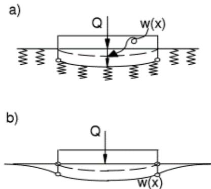
Slika 8.2 Winklerov model (a) i stvarni nosač (b)
