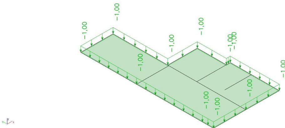
Slika 4.1.2 Dodatno stalno djelovanje  $Q$  [ $\text{kN/m}^2$ ]
