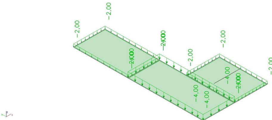
Slika 4.2.2 Dodatno stalno djelovanje  $Q$  [ $\text{kN/m}^2$ ]
