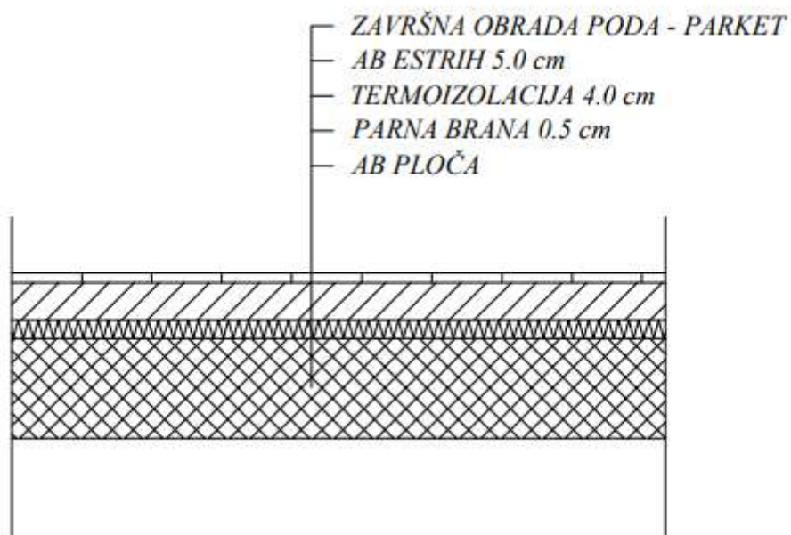
Slika 2.8. Presjek međukatne ploče – prikaz slojeva
