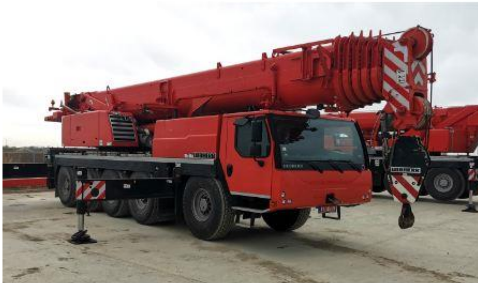
Slika 4.4. Autodizalica Liebherr LTM 1100 [8]
