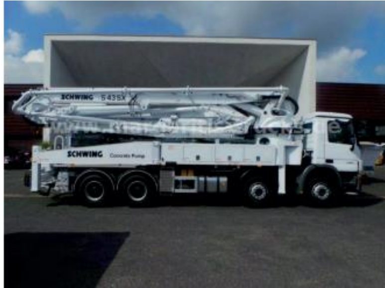
Slika 4.8. Pumpa za beton Mercedes Benz 3541[15]
