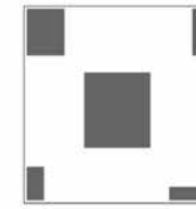
uvođenje svjetlosti i stvaranje odnosa kuće s nebom kroz centralni atrij i svjetlarnike
