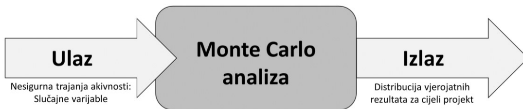
Slika 5.2. Shematski prikaz simulacije primjenom Monte Carlo analize
