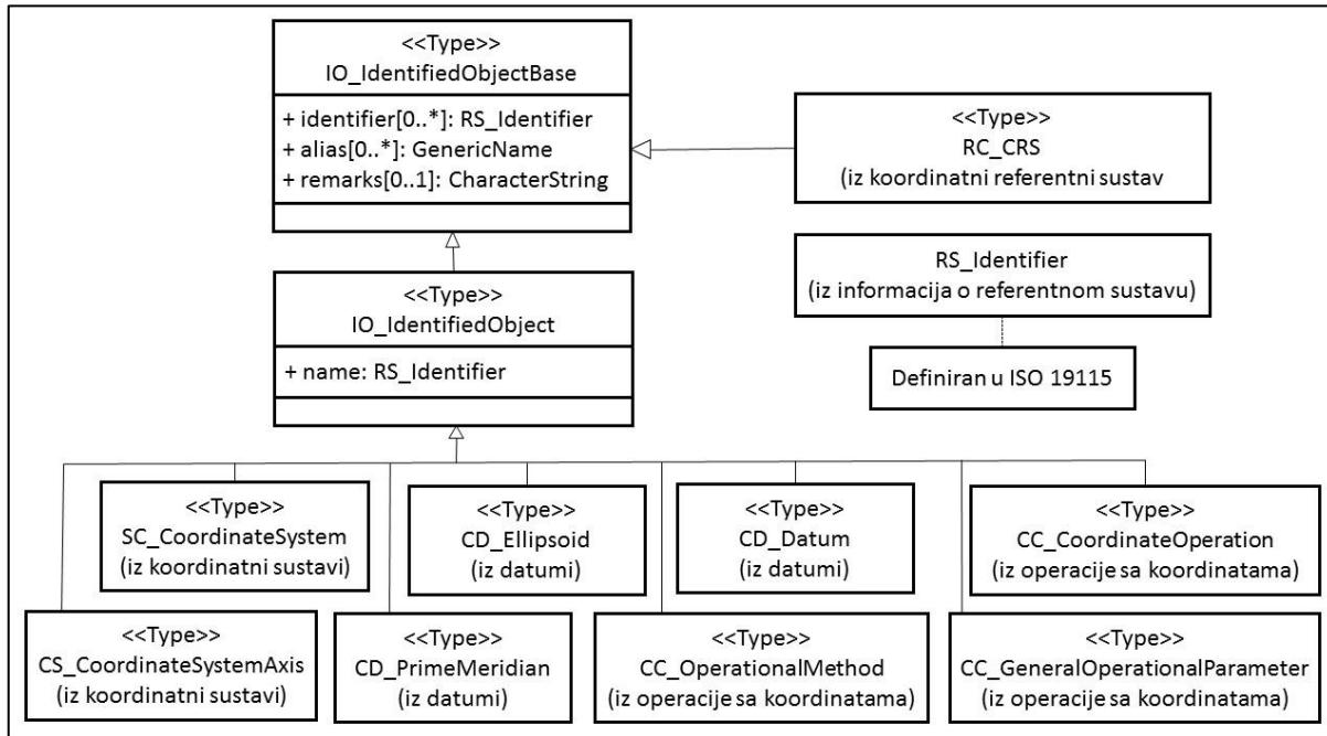
Slika 2: Pojednostavljena ISO UML shema referentnog sustava.
