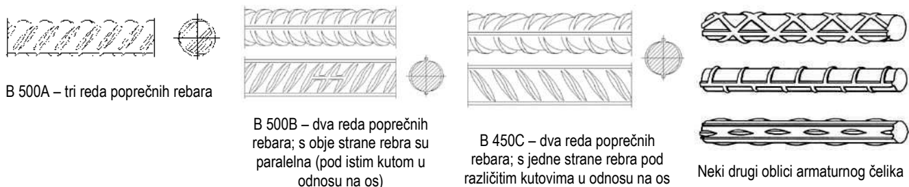
Slika 2.13 – Oblici armaturnog čelika
