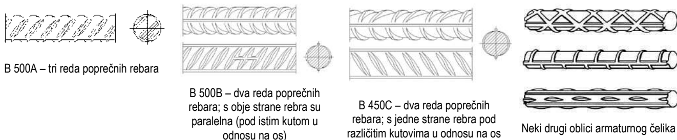
Slika 2.13 – Oblici armaturnog čelika
