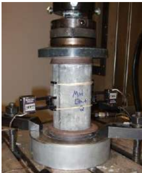
Slika 2.2 – Testiranje uzorka betona
