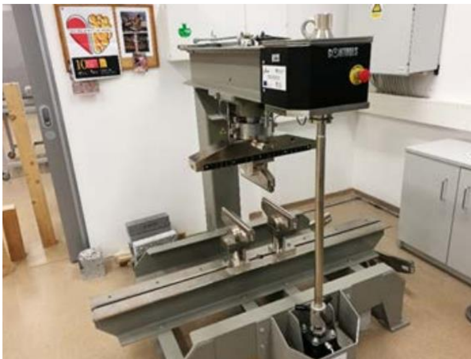
Slika 5.8.1. Okvir za ispitivanje savojne čvrstoće [27]
