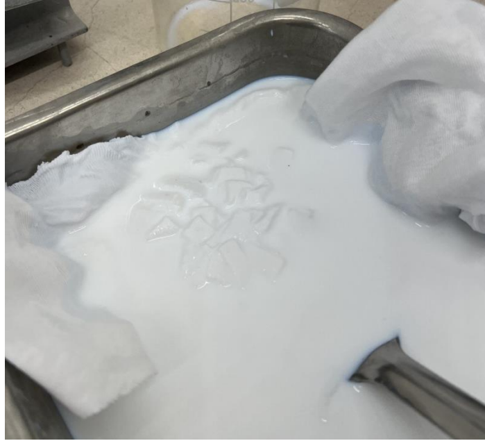
Slika 5.7.2. Tekstilne krpice u vodenj otolini Betona 1
