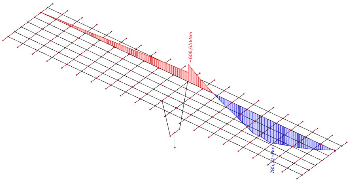
Slika 19. Pokretno opterećenje - momentni dijagram  $M_y$  (kNm)
