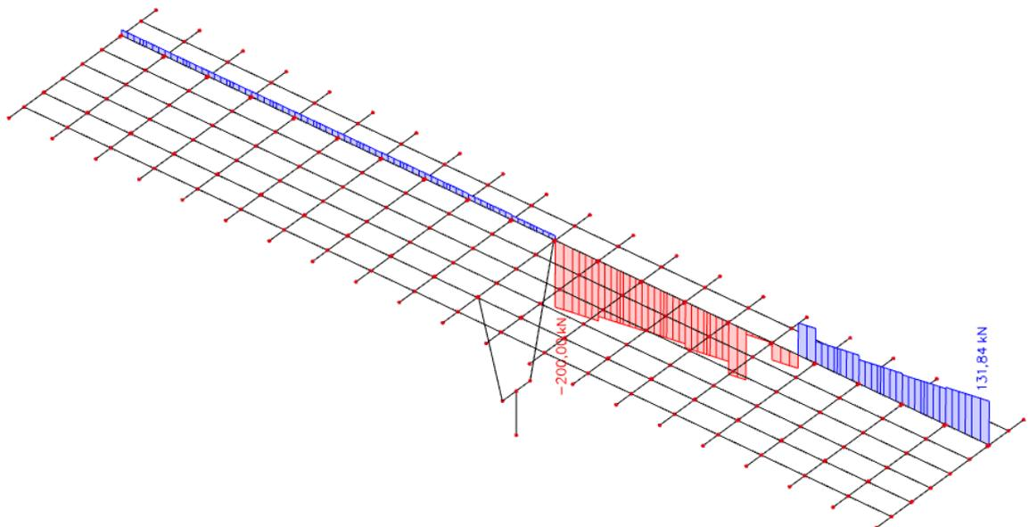
Slika 20. Pokretno opterećenje – dijagram poprečne sile  $V_z$  (kN)
