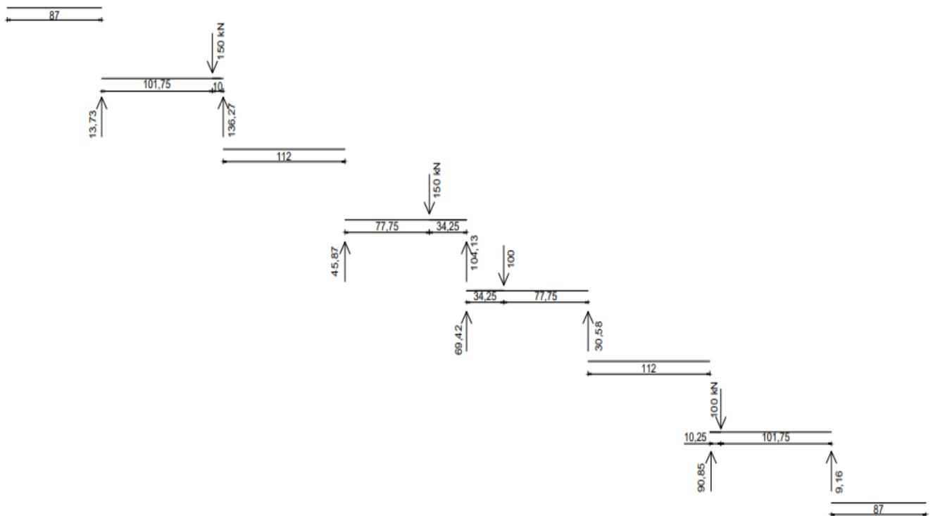
Slika 16. Prikaz raspodjele koncentrirane sile od tipskog vozila
