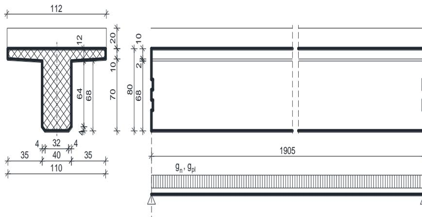
Slika 2. Uzdužna i poprečna dispozicija jednog nosača
