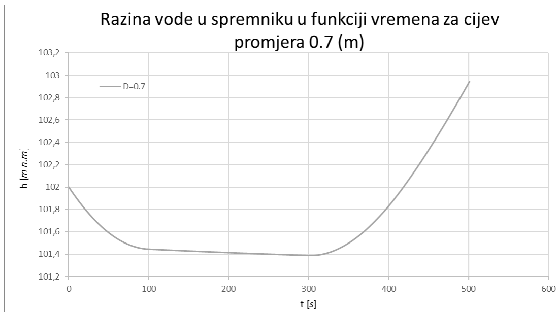
Slika 12. Razina vode u spremniku u funkciji vremena za cijev promjera 0.7 (m), duljine cijevi od 100 (m)
