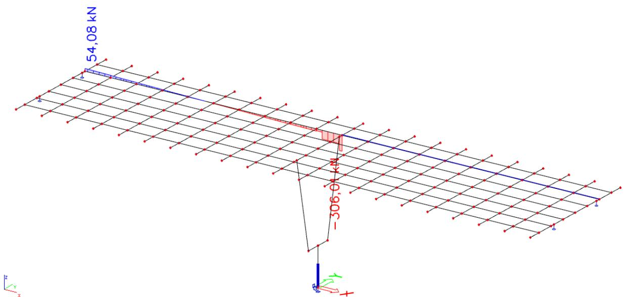
Slika 25. Pokretno – maksimalna poprečna sila pri stupu – poprečne sile ( $Vz$ ) u  $\text{kN}$
