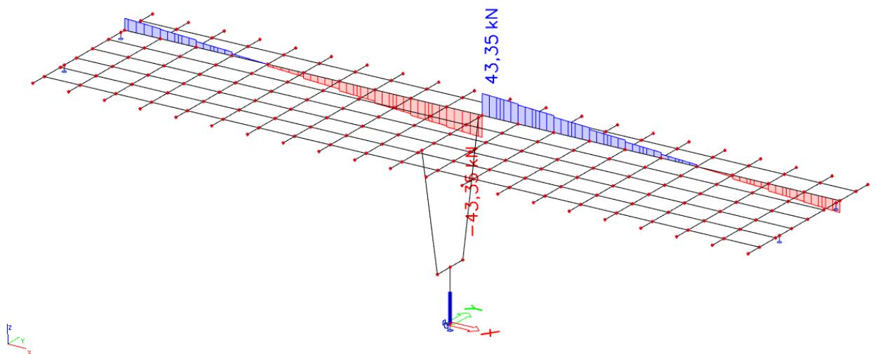
Slika 12. Dodatno stalno opterećenje – poprečne sile ( $Vz$ ) u  $\text{kN}$
