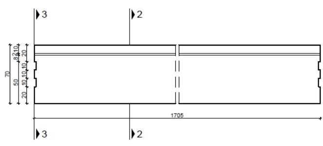
Slika 2. Uzdužna i poprečna dispozicija jednog nosača
