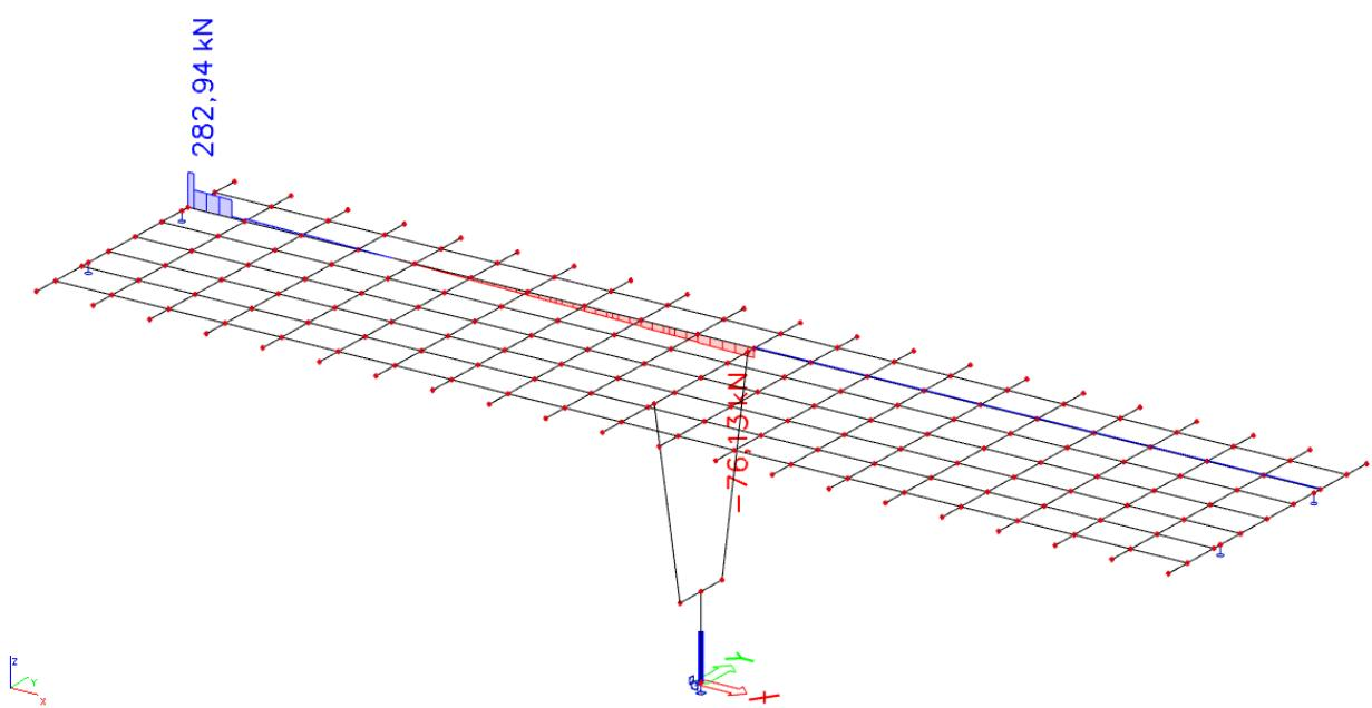
Slika 29. Pokretno – maksimalna poprečna sila pri upornjaku – poprečne sile ( $V_z$ ) u  $\text{kN}$
