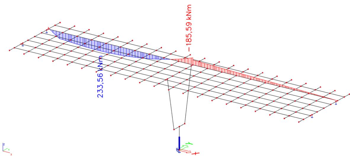
Slika 28. Pokretno – maksimalna poprečna sila pri upornjaku – momenti ( $M_y$ ) u  $\text{kNm}$
