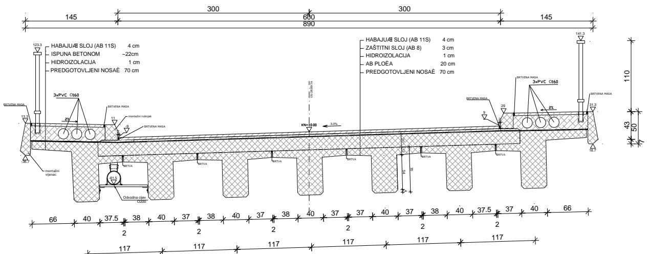
Slika 1. Poprečni presjek rasponske konstrukcije
