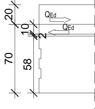
Slika 33: Poprečni presjek spregnutog T nosača
