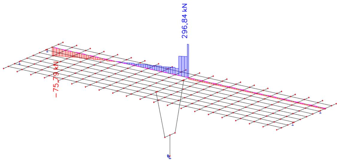
Slika 26. Pokretno opterećenje – maksimalna poprečna sila pri stupu – poprečne sile  $V_z$  (kN)
