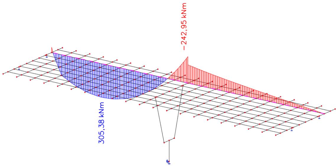
Slika 29. Pokretno opterećenje – maksimalna poprečna sila pri upornjaku – momenti  $M_y$  ( $kNm$ )
