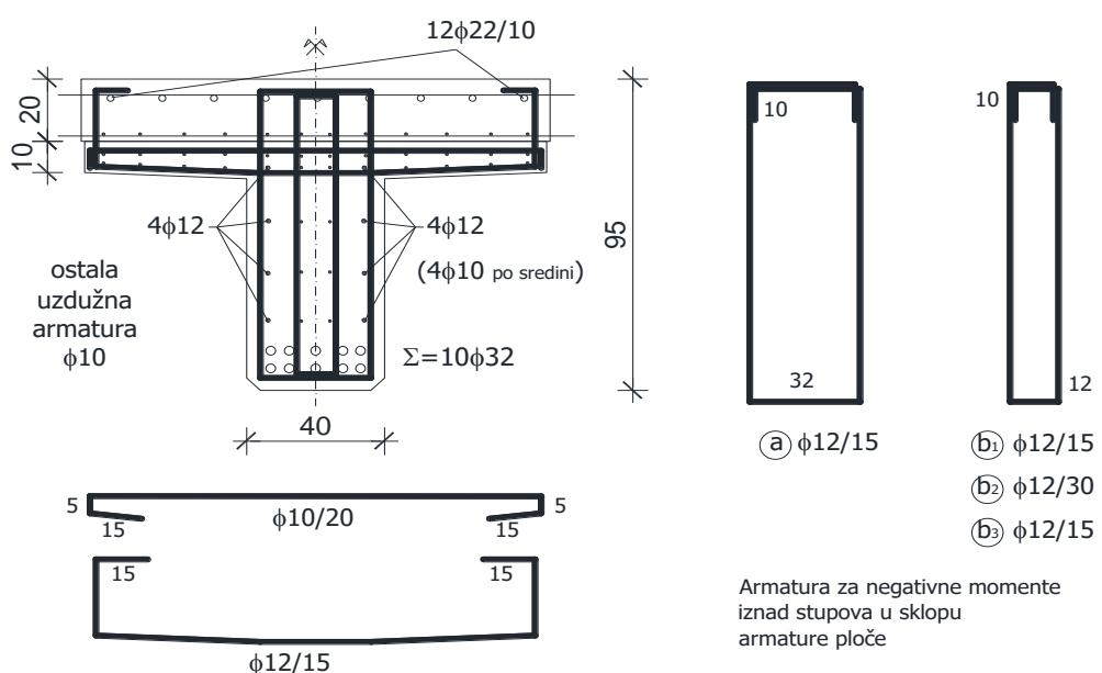
Slika 34. Prikaz armiranja nosača u presjeku a-a
