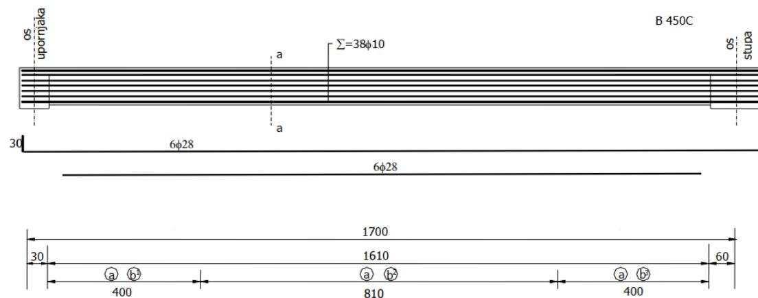
Slika 33. Prikaz armiranja uzdužnog nosača u polju
