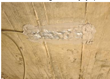
Slika 6. Mjerni senzori na betonu i prednapetom čeliku
