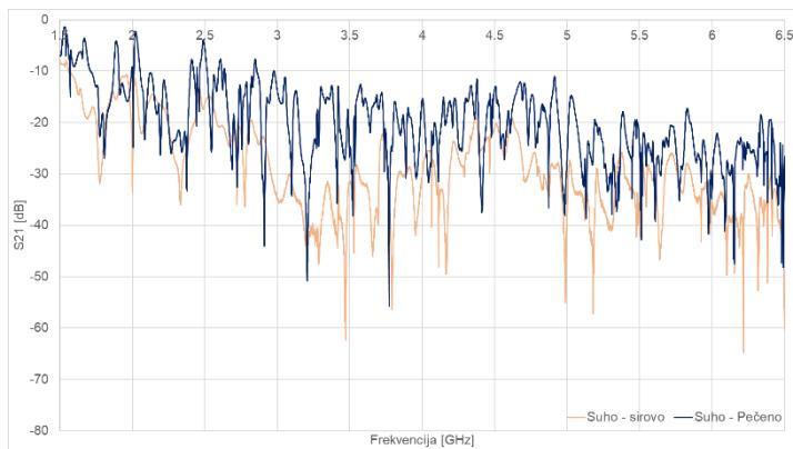
Slika 5. Usporedba zaštite sirove i pečene opeke
