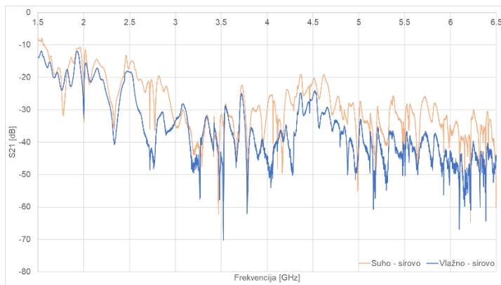
Slika 4. Usporedba zaštite suhe i vlažne opeke
