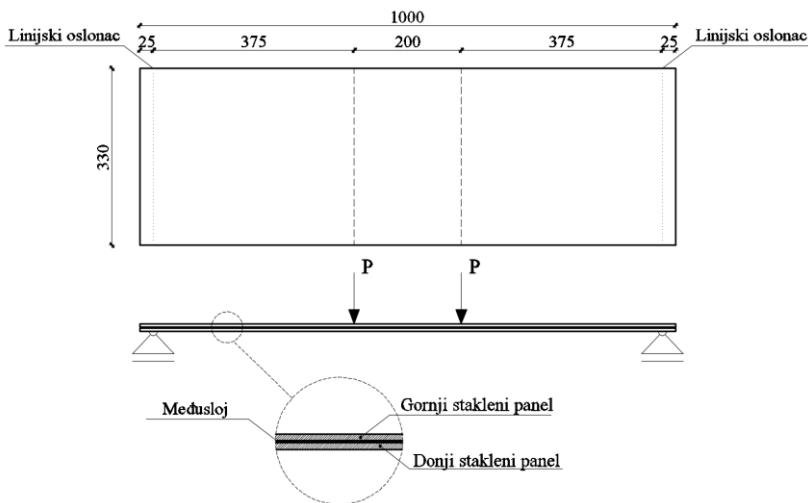
**Slika 3.** Prikaz statičkog sustava, opterećenja i oblika poprečnog presjeka korištenog u numeričkoj analizi [26]
