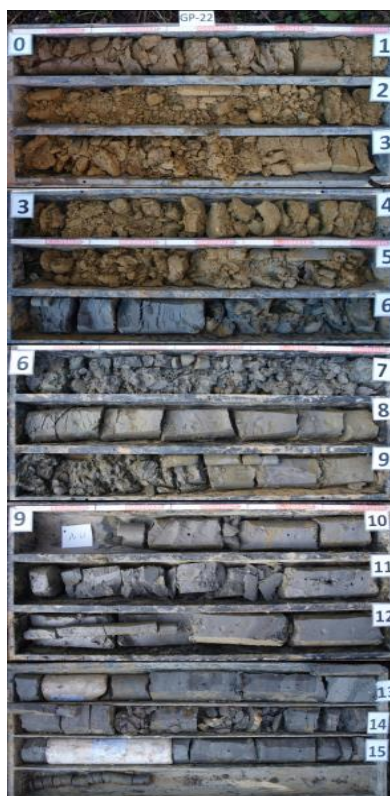
Slika 5. Fotodokumentacija jezgre bušotine GP-22 [3]
