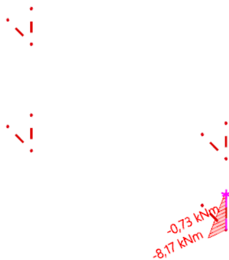
Slika 11.68. Prikaz pripadajućeg momenta savijanja za kombinaciju GSN - CO1
