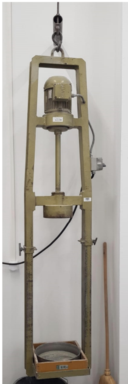
Slika 16. Uređaj za prosijavanje agregata
