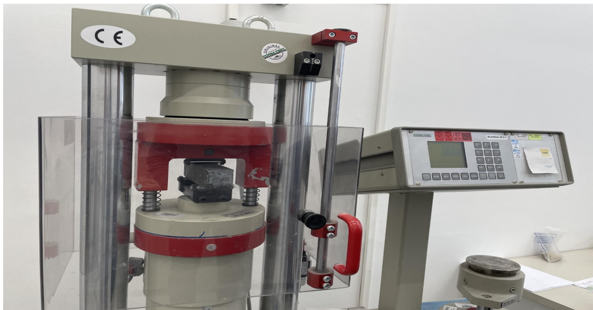
Slika 27. Ispitivanje savojne čvrstoće UHPC betona
