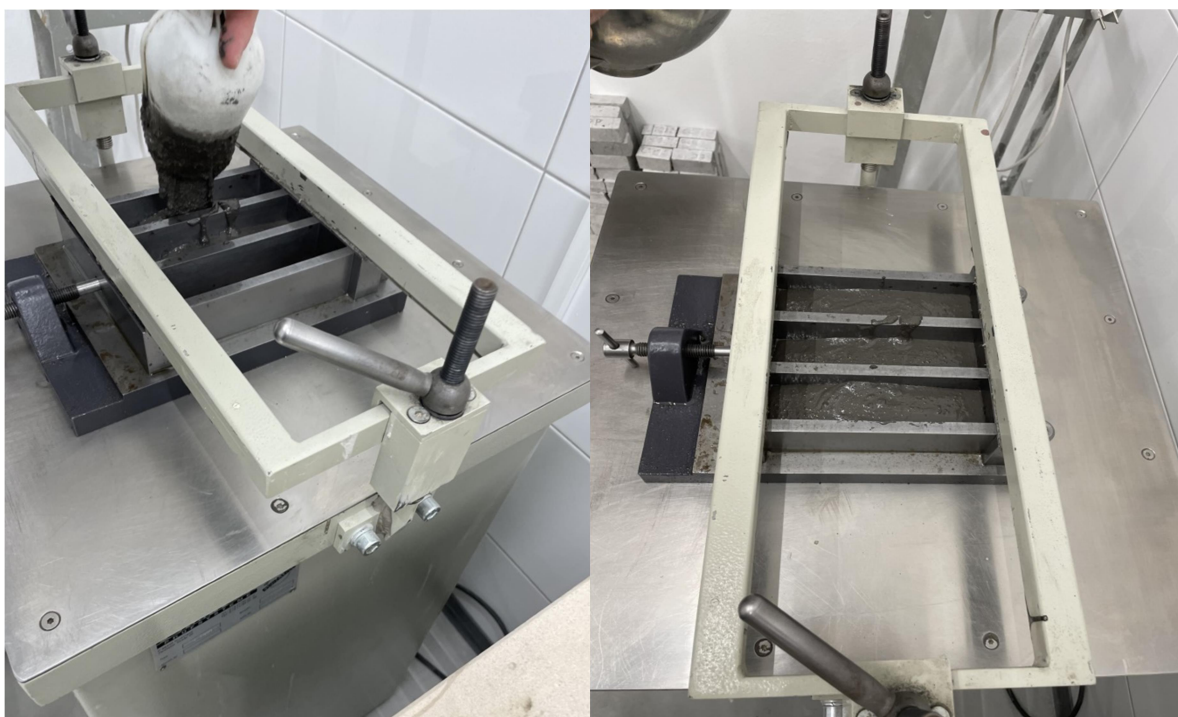
Slika 23. Svježi UHPC beton u kalupima na vibro stolu
