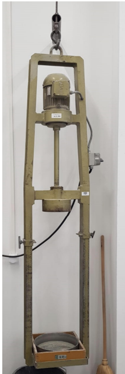
Slika 16. Uređaj za prosijavanje agregata
