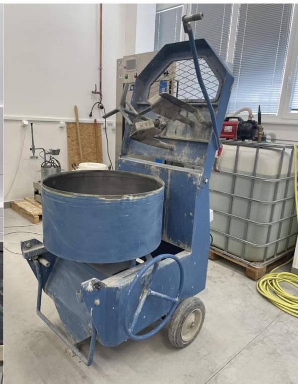
Slika 21. Laboratorijska miješalica za beton
