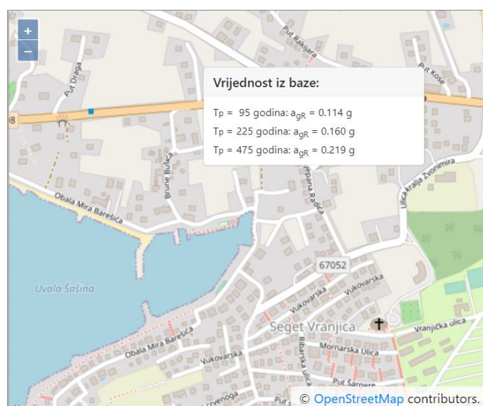
Slika 4.24 Seizmološka karta, prikaz parametara za lokaciju Seget Donji
