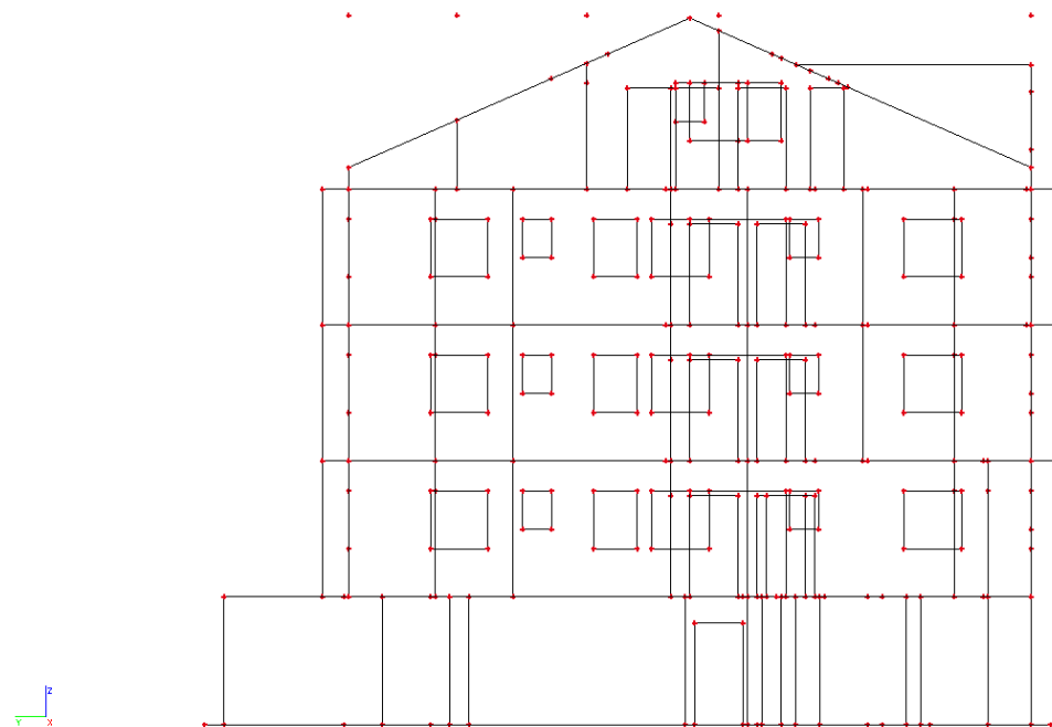
Slika 9.4 Model za proračun ( pogled u y smjeru )
