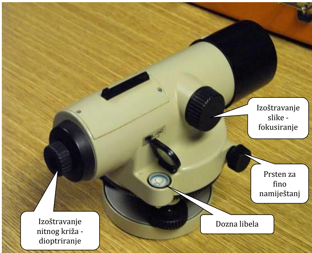
Slika 6.3. Sastavni dijelovi nivelira
