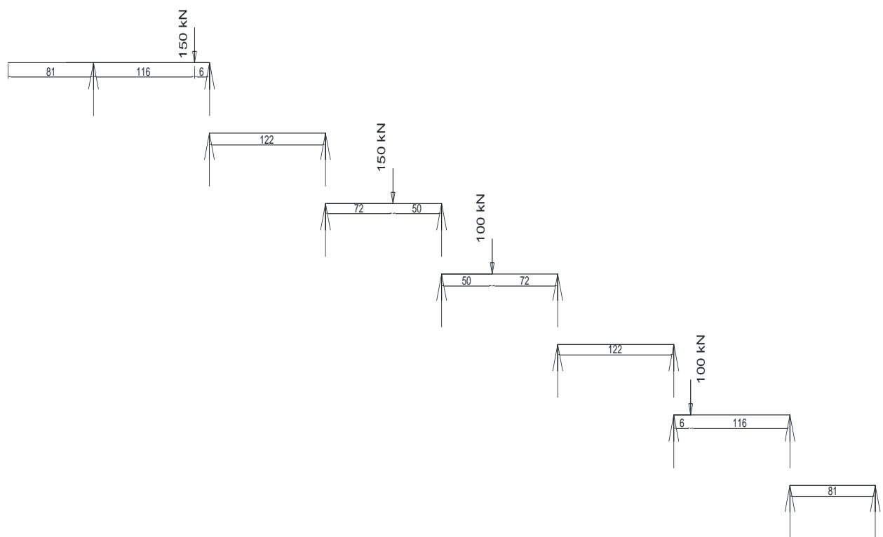
Slika 166. Prikaz raspodjele koncentriranih sila od tipskog vozila
