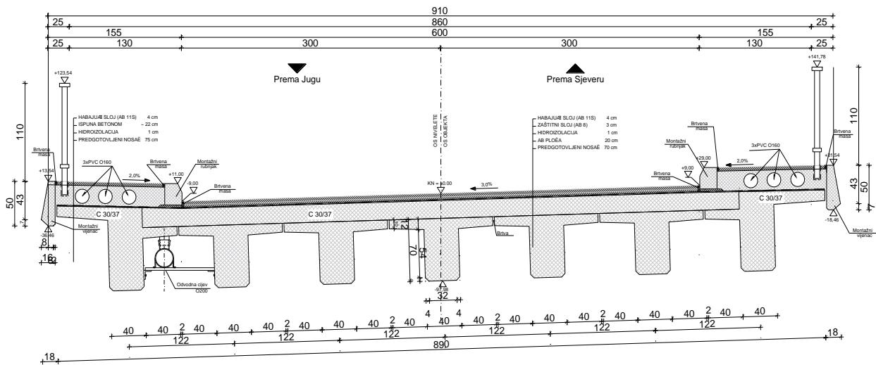
Slika 1. Poprečni presjek rasponske konstrukcije
