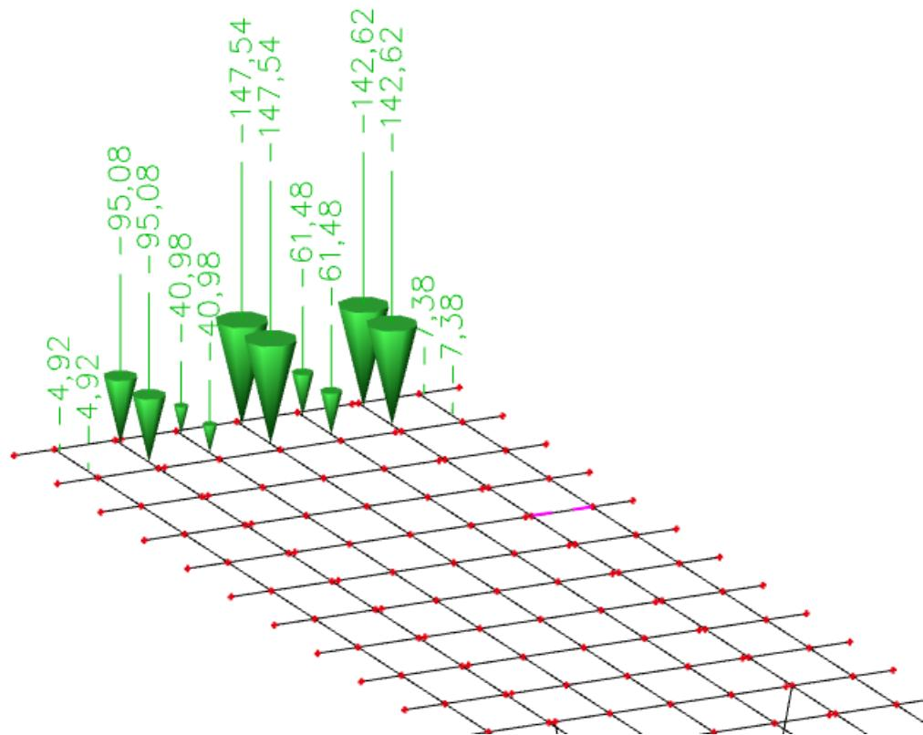
Slika 27. Prikaz tipskog vozila за максималну попрећну силу при упорнику
