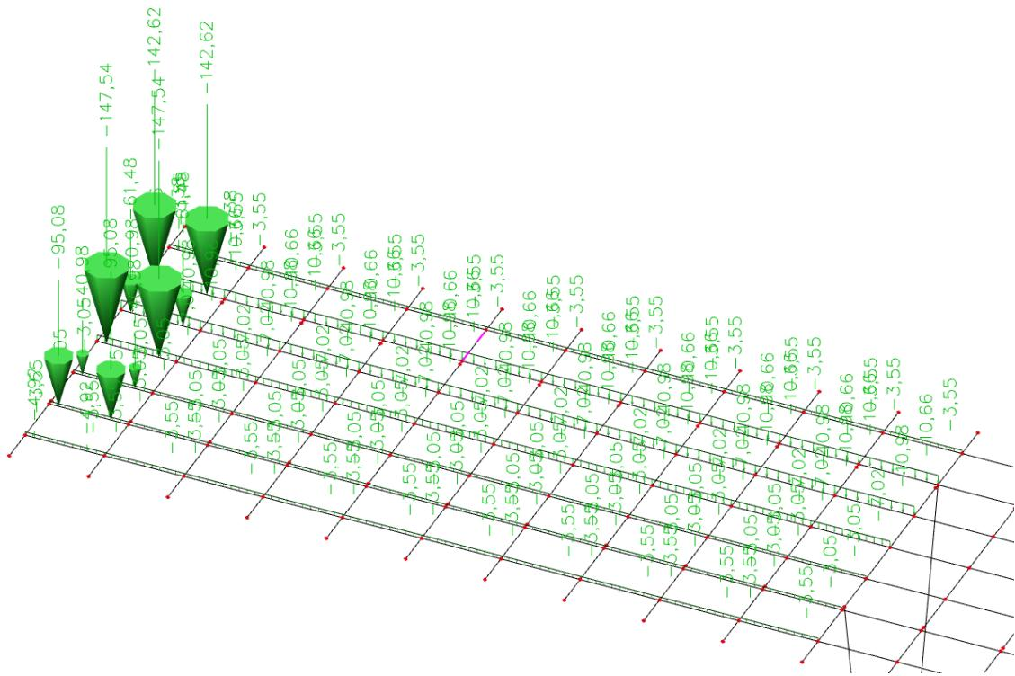
Slika 26. Pokretno opterećenje za maksimalnu poprečnu силу при упорнику
