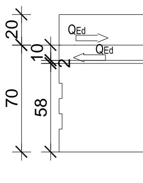
Slika 33: Poprečni presjek spregnutog T nosača
