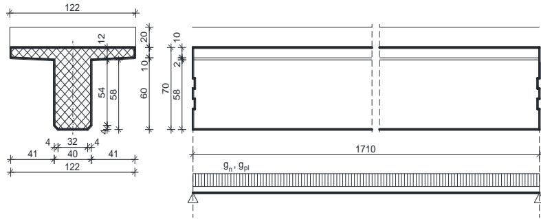
Slika 2. Uzdužna i poprečna dispozicija jednog nosača
