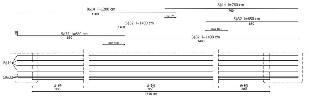
Slika 35. Uzdužni presjek nosača
