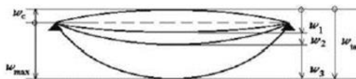
Slika 7.3 Prikaz progiba grede
