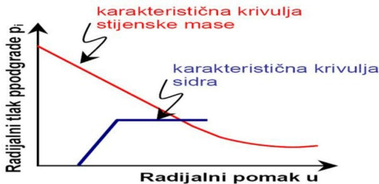
Slika 6.3. Karakteristična krivulja podgrade
