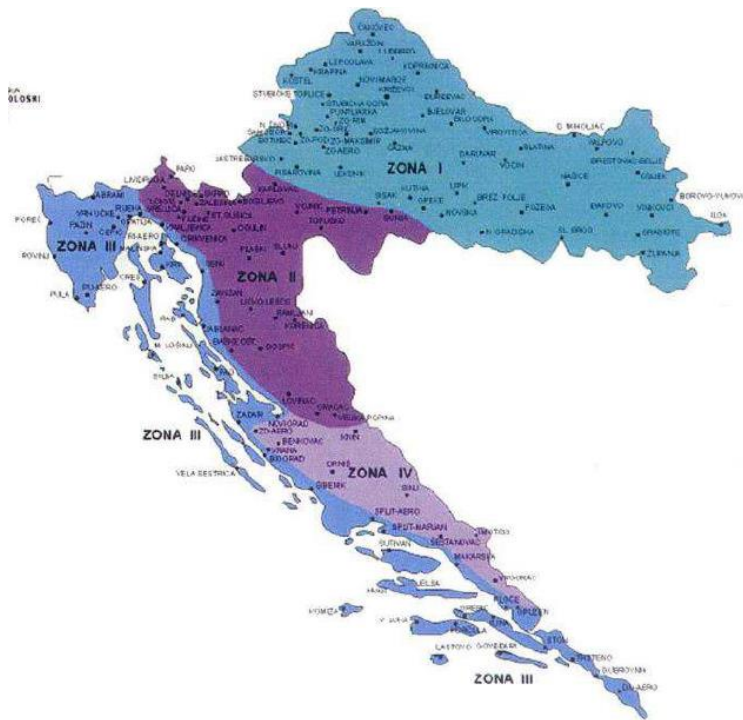
Slika 6.1 Klimatske zone karakterističnog opterećenja snijegom
