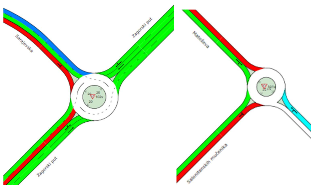
Slika 44. Stupanj zasićenosti ( kružni tok Sarajevska – Zagorski put)
